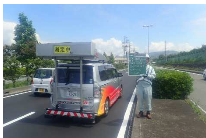
写真－1 路面性状車計測状況
