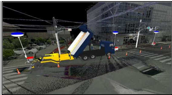
図-3 規制材配置BIM/CIMデータ 図-4 ダンプ荷台高さや架空線高さの検討
