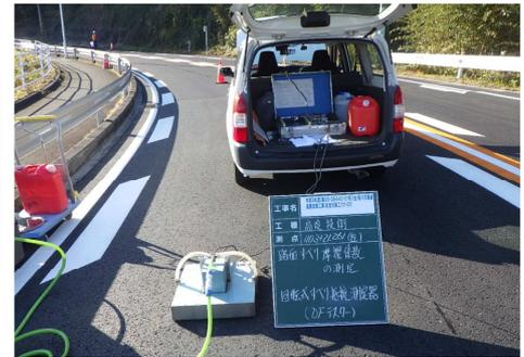
写真-6 路面すべり摩擦係数測定
