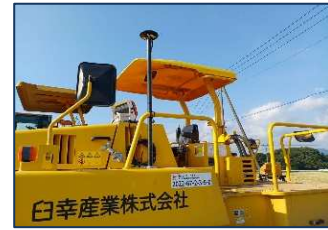
写真-4 スマートローラー GPS受信機
